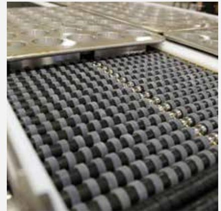
SLIP-TORQUE ROLLER CONVEYOR
